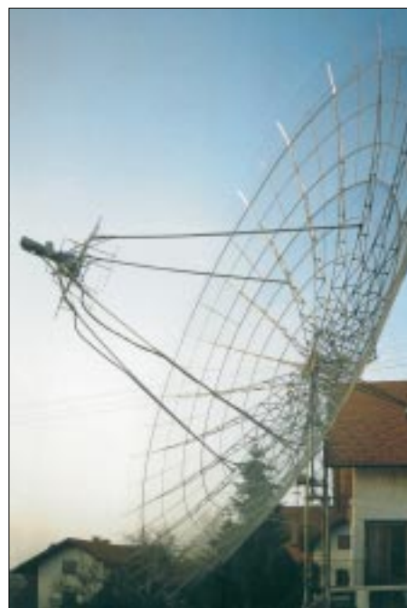
Bild 17: Mit diesem 11-m-Spiegel ist Johannes, OE5JFL, auf 2 m, 70 cm und 23 cm QRV. Polarisationsumschaltung beschränkt sich hier auf den Erreger, vgl. a. [19].
