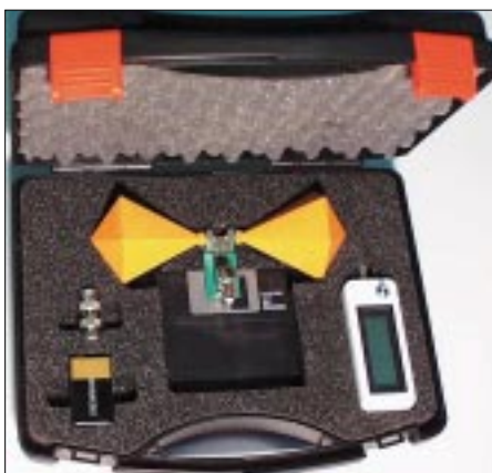
Der Feldstärke-Meßkoffer II von SSS erlaubt Messungen von 50 bis 2000 MHz [17].
