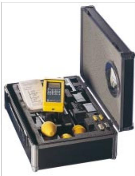
Kommerzieller Feldstärke-Meßkoffer von Wandel & Goltermann [12]
