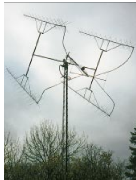
Bild 19: Die in X-Polarisation aufgebaute Antennengruppe von SM5BSZ läßt problemlose, elektronisch Umschaltung zwischen verschiedenen Polarisationen zu.
