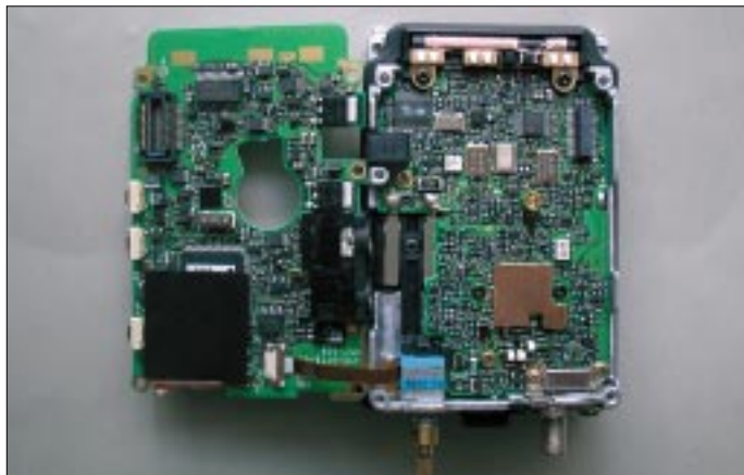
Die Oberseite der Digitalplatine mit der Mikrofonkapsel, im Gehäuseoberteil ist noch der winzige Lautsprecher. Fotos: DG1NEJ
