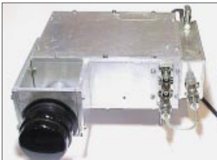
Bild 14: Fertig aufgebaute VFO im Gehäuse aus 5 mm dicken Aluminiumplatten
