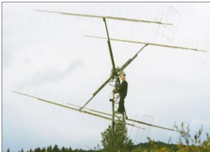
Bild 16: Wahlweise horizontale und vertikale Polarisation mit je viermal 18 Elementen bei Finn, LA8YB, in JO59FR
